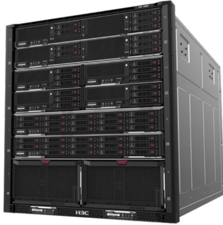
H3C UIS 9000 超融合刀片一体机是新华三自主研发的新一代融合了计算节点、存储节点、交换模块、电源模块、散热模块、OM 管理模块，UISM 管理模块于一体，适用于多种应用需求的超融合刀片一体机。H3C UIS 9000 机箱高 12U，可容纳 16 片半宽计算节点、8 片全宽计算节点、8 片全宽存储节点或者三者的灵活搭配，最大支持 2 个管理模块，8 个网络模块，12 个风扇模块，6 个电源模块，均支持冗余配置，用户可根据需求灵活选择配置。中置超高带宽无源背板连接计算存储节点和交换模块，并通过 OM 管理模块，管理计算存储节点、网络，散热，电源等系统。底部提供两个独立的 UISM 管理模块槽位，可选配额外的 UISM 管理引擎模块，预装 UIS 6.5 超融合软件，支持可选 LCD 模块，满足用户对 LCD 有需求的应用场景。
